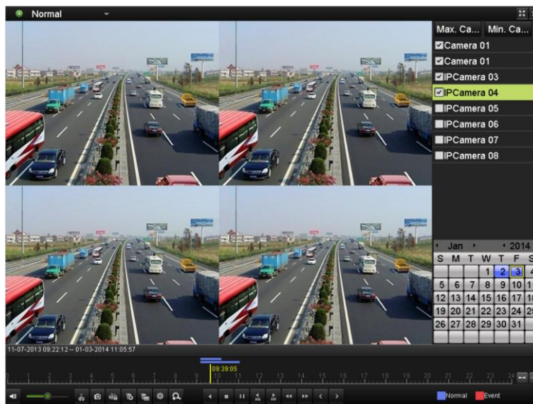
Figure 6. 24 Rozhraní synchronního přehrávání 4 kanálů
